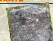
Slepenecký vznikl v prostředí výnosových kuželů a občasných řek přecházejících do pobřežních plošin. Je tvořen drobnými křemennými a buližníkovými valouny obklopené jemnozrnějším štěrkem a pískem. Valouny jsou velikostně vytídené, místa jsou ve slepencích náznaky šíkmého a gradačního zvrstvení. To dokládá změnu směru a rychlosti vodního proudu, které jsou charakteristické pro říční prostředí.
